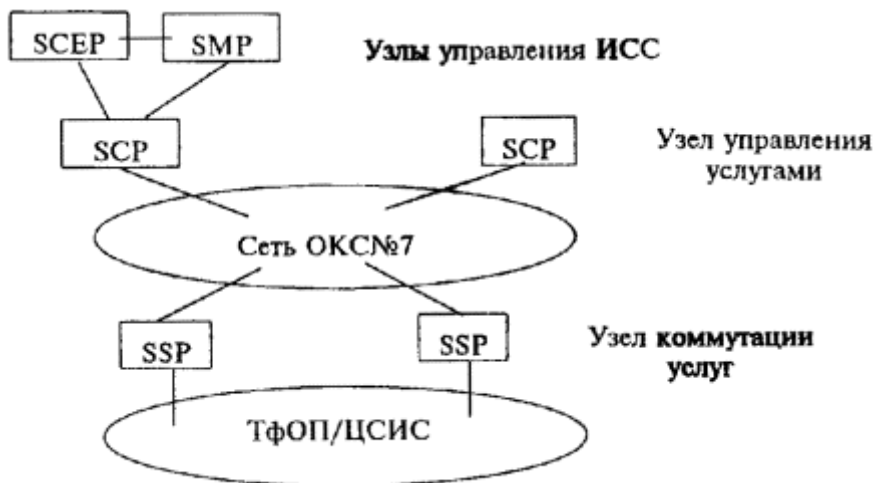
Рис. 5 Типовое построение интеллектуальной сети
